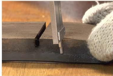
Fig.8 - Inspeção das pastilhas de freio
