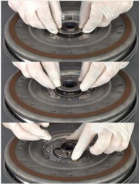
Fig.9 - Montagem do conjunto do rolamento axial posterior.
