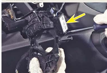
Fig.3 - Desaperto dos parafusos de fixação do imobilizador ao IMF
