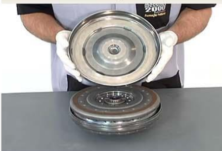
Fig.6 - Carcaça do conversor aberta, apresentando o material de atrito da embreagem de bloqueio.
