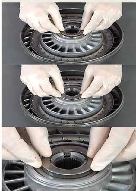
Fig.6 - Montagem da conjunto do rolamento axial intermediário.
