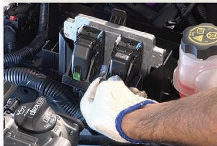
Fig.1 - Remoção dos conectores do MC
