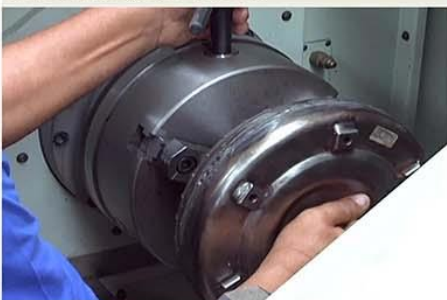
Fig.2 - Centralização do conversor no torno para evitar a remoção não uniforme da solda e usinagem.
