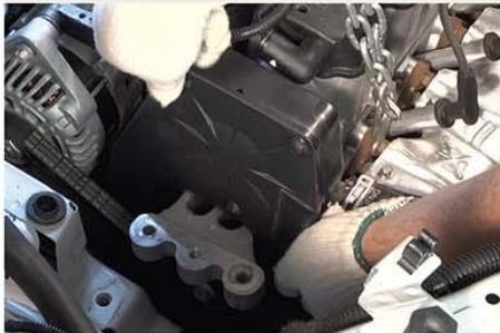
Fig.3 - Remoção da cobertura superior da correia
