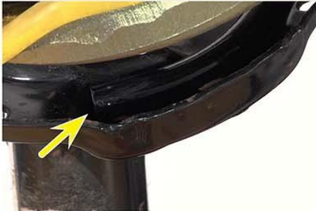
Fig.8 - Encaixe da mola no apoio no amortecedor
