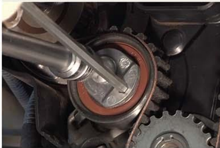
Fig.13 - Ajuste da tensão da correia
