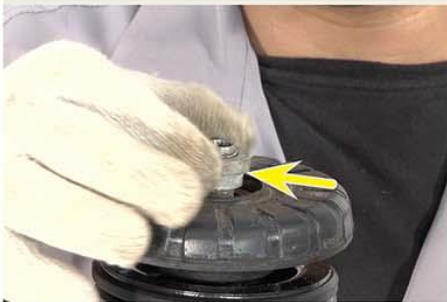
Fig.9 - Instalação da porca de retenção da mola
