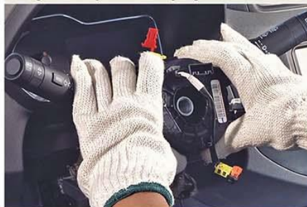
Fig.2 - Remoção do 'clock spring'
