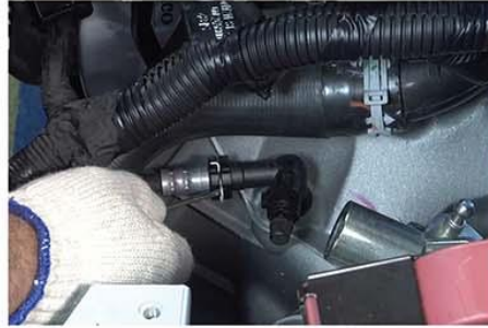
Fig.9 - Desaperto dos parafusos do suporte superior da caixa de marchas
