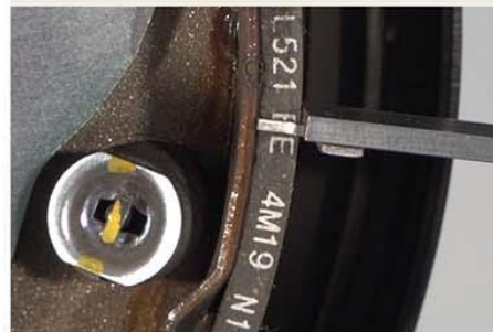
Fig.2 - Inspeção das lonas das sapatas de freio
