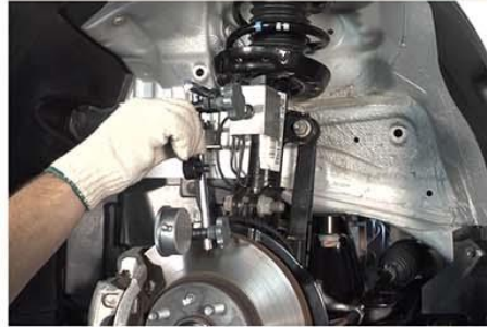
Fig.3 - Inspeção do empeno do disco de freio
