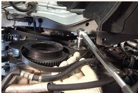
Fig.5 - Remoção da polia da árvore de manivelas
