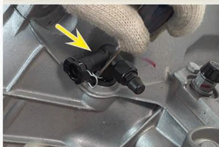
Fig.12 - Remoção da conexão do tubo da embreagem
