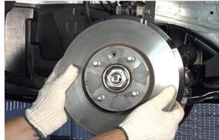
Fig.7 - Remoção do disco de freio
