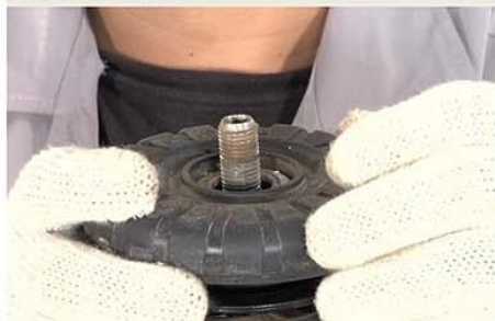
Fig.5 - Remoção do coxim
