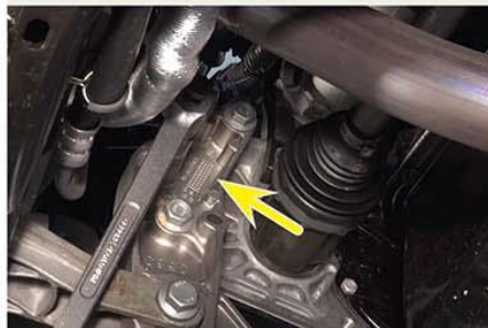
Fig.4 - Remoção dos parafusos do suporte inferior da caixa de marchas
