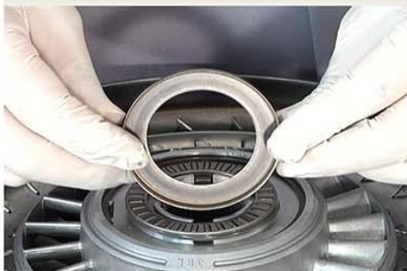
Fig.14 - Apresentação do anel de contenção do grupo do rolamento intermediário.
