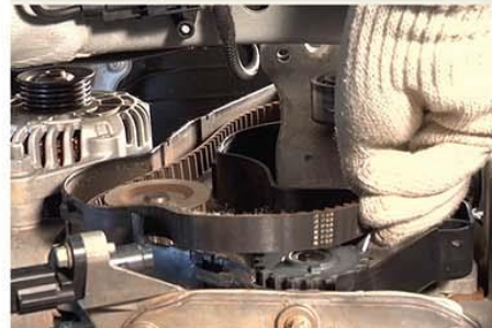
Fig.10 - Remoção da correia dentada
