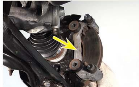
Fig.6 - Remoção do suporte da pinça
