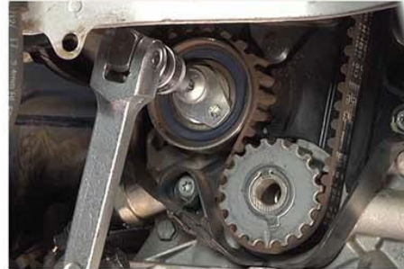
Fig.9 - Desaperto do tensor
