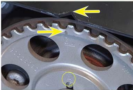
Fig.7 - Referência na engrenagem do comando de válvulas
