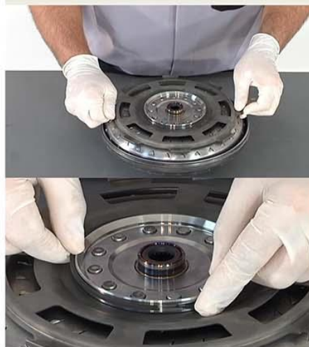
Fig.7 - Instalação da turbina.
