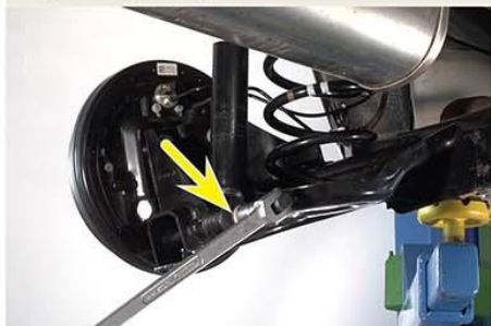
Fig.1 - Desaperto do parafuso inferior do amortecedor
