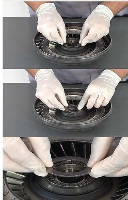
Fig.4 - Montagem do conjunto do rolamento axial anterior.
