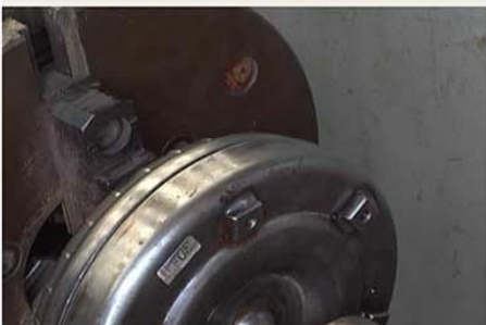
Fig.3 - Detalhe da região usinada. Nessa condição as duas metades da carcaça estão soltas.
