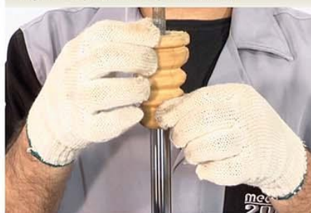
Fig.7 - Posição de instalação do batente
