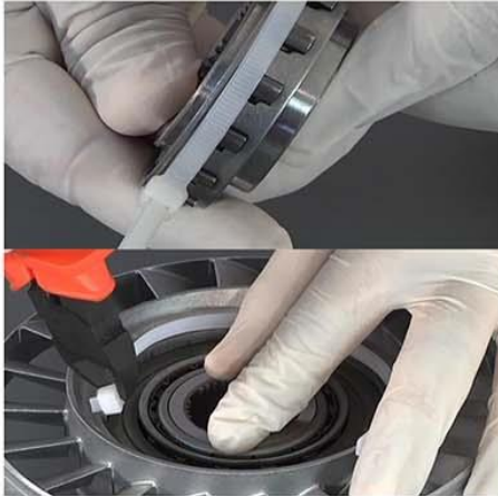
Fig.1 - Montagem da embreagem de bloqueio do estator.
