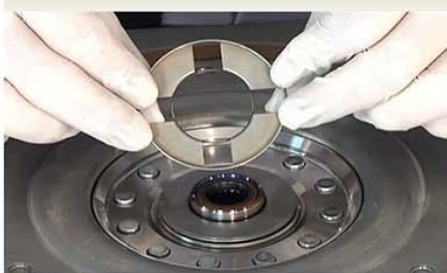
Fig.8 - Anel de contenção e de escoamento de óleo.
