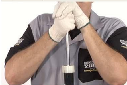
Fig.4 - Desaeração do amortecedor
