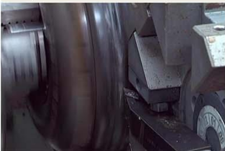
Fig.3 - Detalhe da região usinada. Nessa condição as duas metades da carcaça estão soltas.
