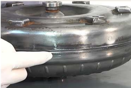
Fig.5 - Região de encontro da bomba e da carcaça anterior, apresentando o local usinado.
