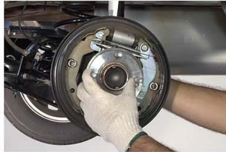
Fig.3 - Remoção do cubo de roda
