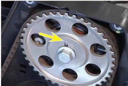
Fig.8 - Inscrição na engrenagem do comando de válvulas
