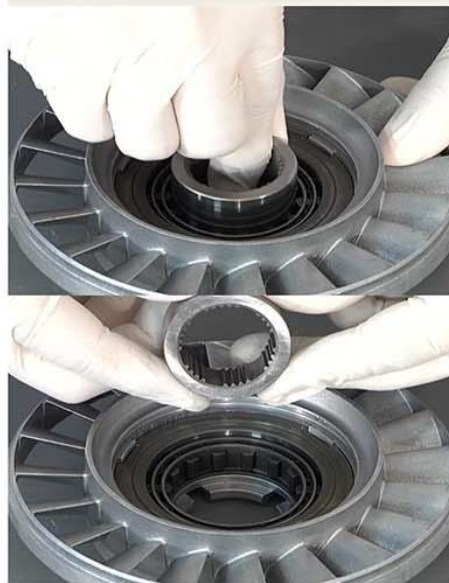
Fig.20 - Remoção da pista da embreagem unidirecional.
