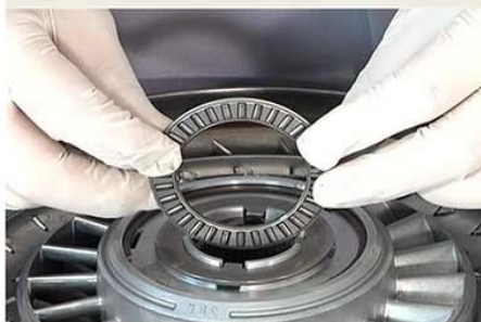
Fig.15 - Rolamento intermediário removido.
