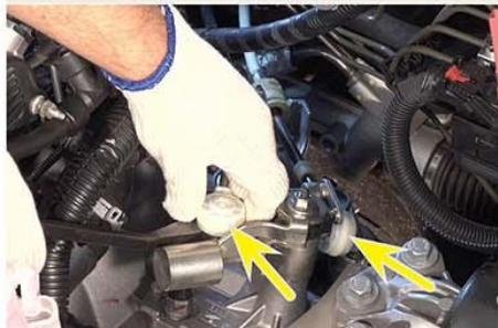
Fig.2 - Remoção dos cabos de seleção e mudança das marchas
