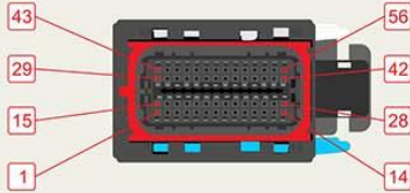
Terminal elétrico do MC - A
