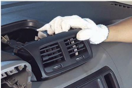
Fig.5 - Remoção do difusor de ar central
