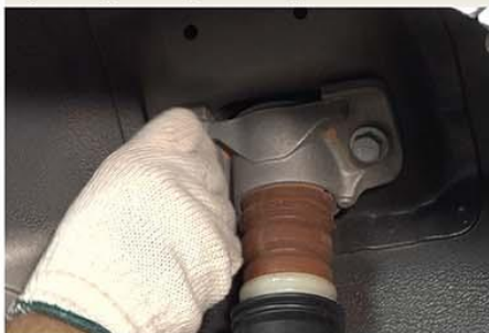
Fig.2 - Desaperto dos parafusos superiores do amortecedor
