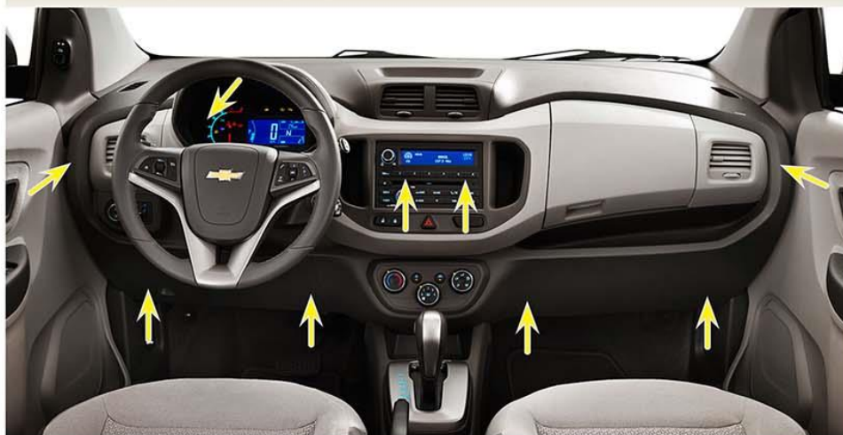
Fig.9 - Localização dos parafusos de fixação do painel
