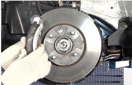
Fig.5 - Remoção das pastilhas
