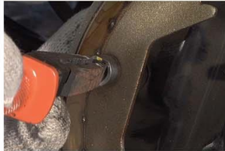
Fig.6 - Remoção da trava da sapata primária
