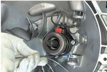
Fig.17 - Instalação do atuador da embreagem
