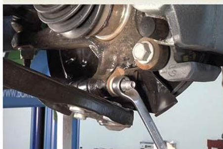
Fig.3 - Remoção do pivô da suspensão
