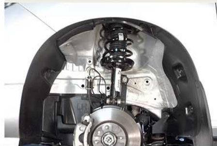
Fig.11 - Torre instalada no veículo
