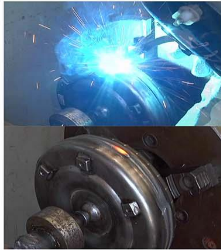
Fig.11 - Soldagem da carcaça.
