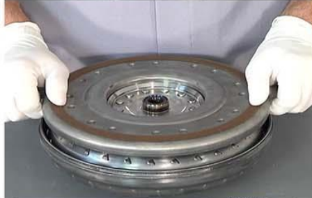
Fig.9 - Apresentação do rolamento axial de encosto do conjunto da turbina.
