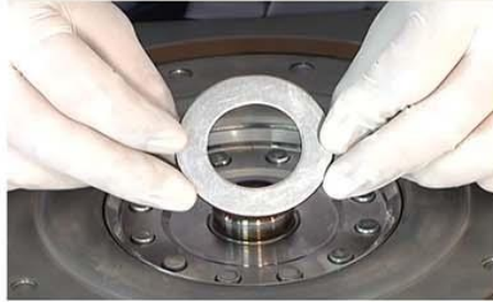
Fig.10 - Remoção do anel espaçador.
