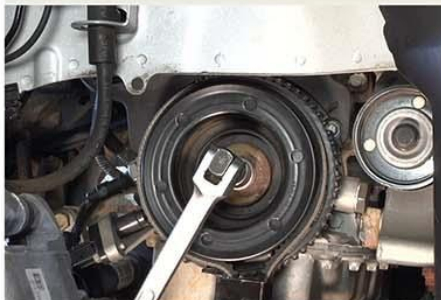
Fig.5 - Remoção da polia da árvore de manivelas
