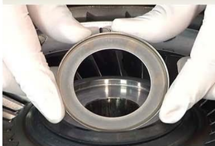
Fig.24 - Anel de contenção anterior removido.
