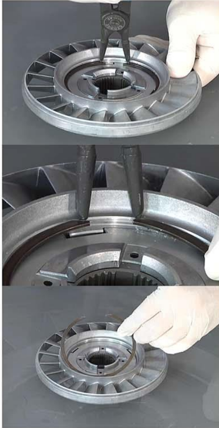
Fig.18 - Remoção do anel elástico de fixação dos componentes do estator.
