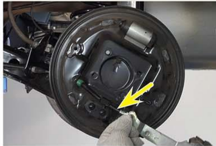
Fig.7 - Remoção do cabo do freio de estacionamento
