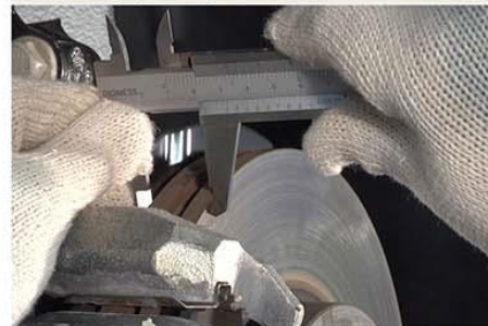
Fig.1 - Inspecção da espessura do disco de freio
