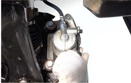
Fig.4 - Remoção da pinça de freio
