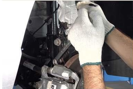
Fig.3 - Desaperto das porcas de fixação da torre da suspensão à manga de eixo
