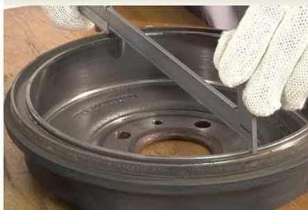
Fig.8 - Inspeção do tambor de freio
