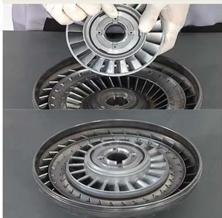
Fig.5 - Instalação do estator.
