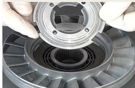
Fig.19 - Remoção da capa da embreagem unidirecional.
