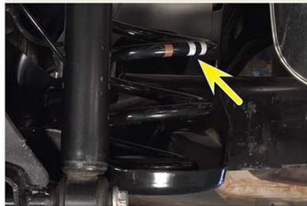
Fig.5 - Marcações de referência na mola da suspensão
