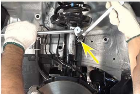
Fig.2 - Remoção da porca superior do terminal da barra estabilizadora
