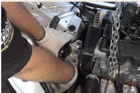
Fig.2 - Remoção do conjunto do suporte do motor
