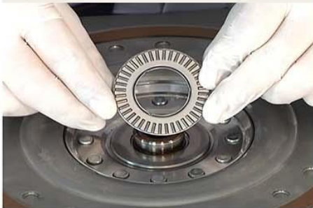
Fig.9 - Apresentação do rolamento axial de encosto do conjunto da turbina.
