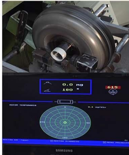
Fig.12 - Balanceamento do conversor.
