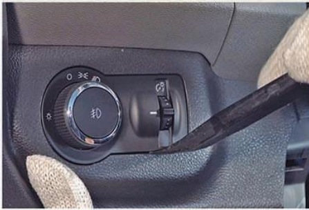
Fig.4 - Deslocamento do interruptor geral de luzes
