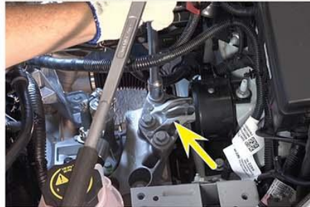
Fig.9 - Desaperto dos parafusos do suporte superior da caixa de marchas
