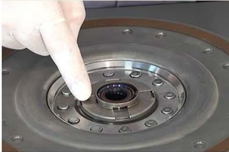
Fig.7 - Anel de contenção apresentando as quatro aberturas para escoamento do fluido de trabalho.
