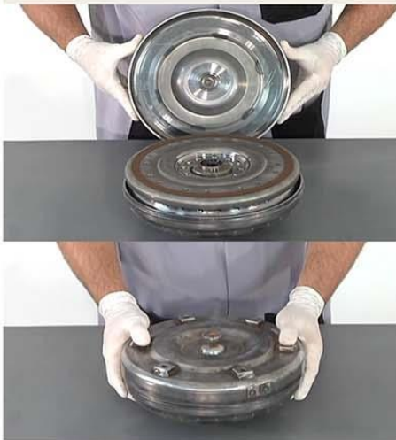
Fig.10 - Montagem da carcaça da bomba
