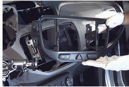
Fig.6 - Deslocamento da guarnição frontal
