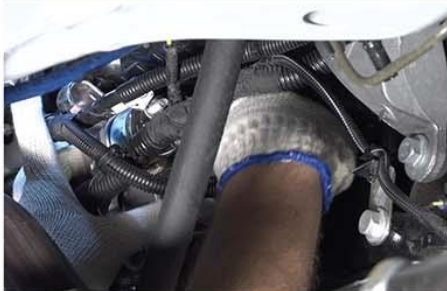
Fig.7 - Remoção do motor de partida
