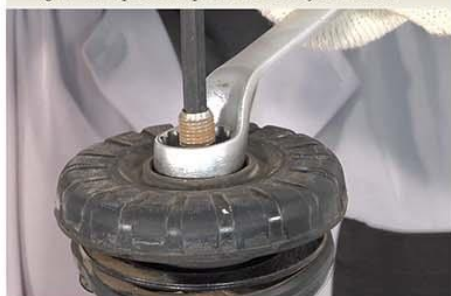
Fig.4 - Desaperto da porca de retenção da mola
