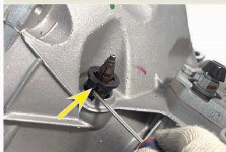
Fig.13 - Remoção da trava da tubulação do atuador
