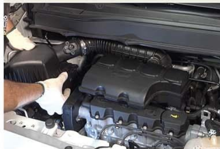
Fig.1 - Remoção do conjunto filtro de ar
