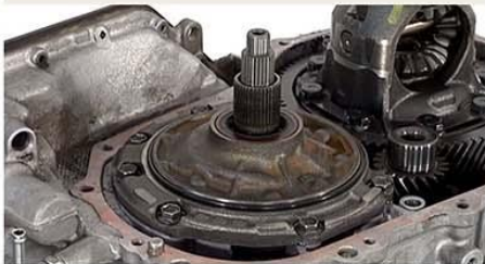
Fig.23 - Remoção da bomba de óleo.
