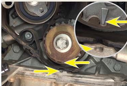
Fig.6 - Referência na engrenagem da árvore de manivelas
