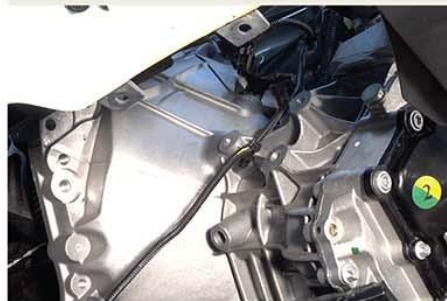
Fig.10 - Remoção da caixa de marchas
