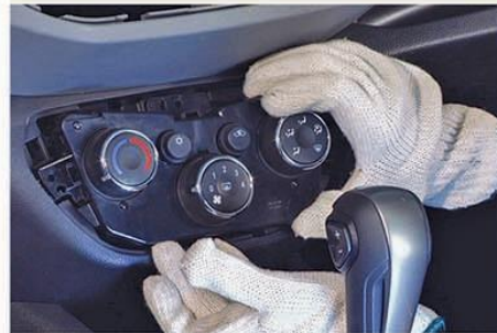
Fig.7 - Deslocamento do painel de controle do ar
