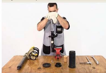
Fig.6 - Desaeração do amortecedor
