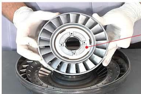
Fig.20 - Esquema do conversor de torque, destacando seus principais componentes: Bomba, turbina, estator, assim como o desenho geométrico de seus componentes.
