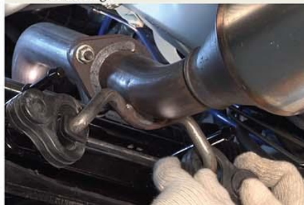
Fig.5 - Remoção das borrachas de fixação do cano de descarga
