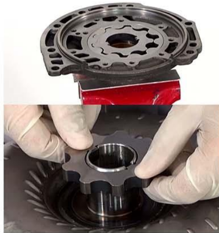
Fig.24 - Aspecto da bomba e seu acionamento.
