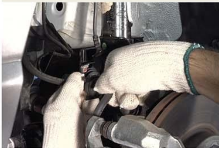
Fig.1 - Remoção do cabo do conduíte de freio
