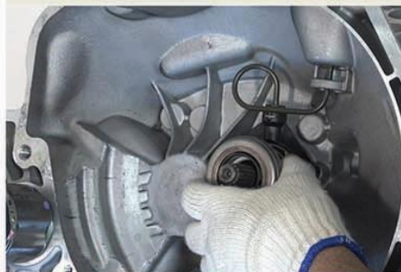
Fig.14 - Remoção do atuador da embreagem
