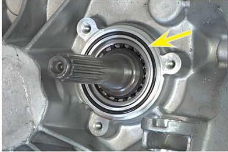
Fig.16 - O-ring instalado na caixa
