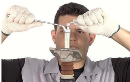
Fig.3 - Desaperto da porca de fixação da haste do amortecedor
