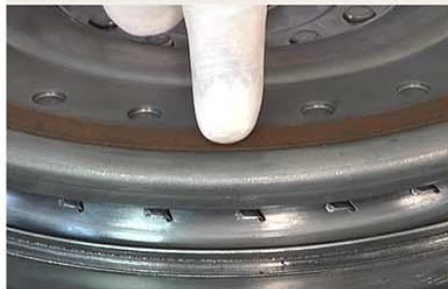
Fig.11 - Remoção do disco da embreagem de bloqueio com o conjunto de molas redutoras de vibração.
