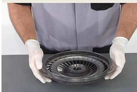
Fig.25 - Apresentação da bomba do conversor.
