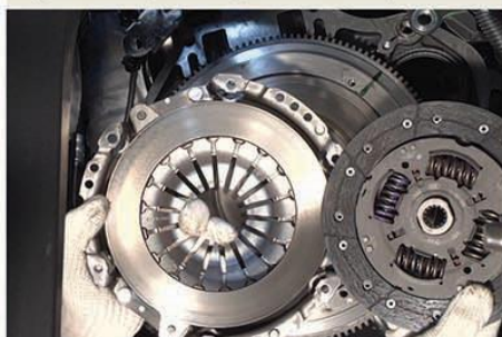
Fig.11 - Remoção do conjunto da embreagem
