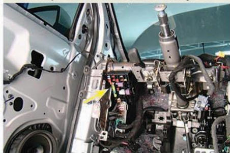
Localização da caixa de relés e fusíveis do painel
