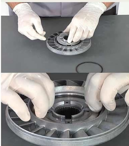
Fig.2 - Montagem da capa da embreagem.
