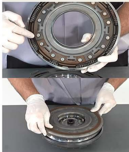
Fig.8 - Instalação da embreagem de bloqueio.
