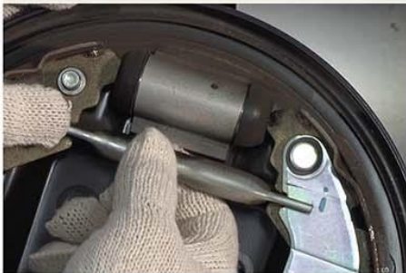
Fig.5 - Remoção da unidade de ajuste
