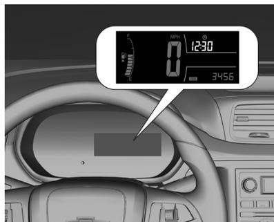
Para ajustar la hora en la pantalla del modelo A, pulse el botón **MENU** en la palanca de los intermitentes y gire el mando hacia arriba o hacia abajo hasta que aparezca.
