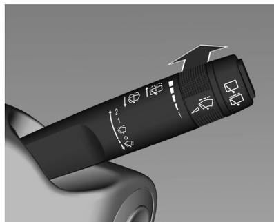
Pulse la palanca. Se pulveriza líquido de lavado sobre la luneta trasera y el limpiavientos se acciona varias veces.
