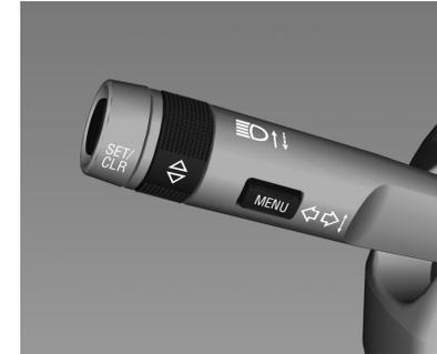
Para activar la computadora de a bordo, pulse el botón **MENU** en la palanca de los intermitentes.
