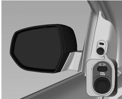
El mando de los retrovisores eléctricos está situado en el revestimiento de la puerta, al lado del conductor. Seleccione el retrovisor izquierdo o derecho con el selector y ajústelo con el mando de cuatro posiciones.
