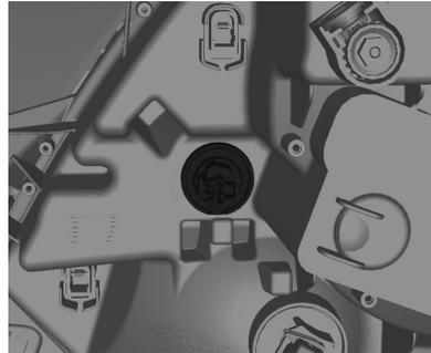
3. Desmonte el casquillo de la lámpara de la luz lateral del reflector.
