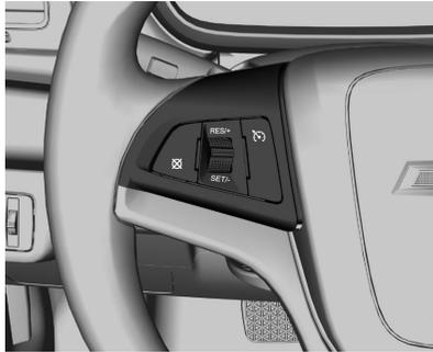
El Control de Velocidad Crucero se puede manejar con los mandos del volante.
