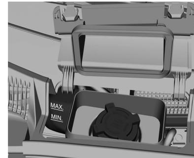
5. Saque el tapón del depósito de combustible para arranque en frío girándolo en sentido antihorario.
