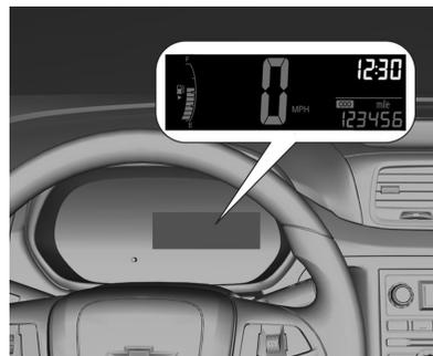
Para ajustar la hora en la pantalla del modelo B, pulse el botón del cuadro de instrumentos durante menos de 2 segundos, como se muestra en la imagen inferior.
