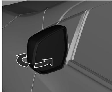
Para la seguridad de los peatones, los retrovisores exteriores basculan de su posición de montaje normal al recibir impactos de una determinada fuerza. Vuelva a colocar el retrovisor en su posición presionando ligeramente sobre la carcasa. Esta función también es útil para reducir la anchura total del vehículo y evitar daños cuando el vehículo está aparcado. Vuelva a colocar el retrovisor en su posición de funcionamiento antes de conducir.
