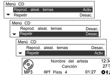
Gire el control **MENU-TUNE** para seleccionar las funciones de reproducción aleatoria o repetición y pulse el botón **MENU-TUNE** para activar o desactivar las funciones relevantes.
