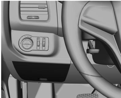
La caja de fusibles está detrás de una tapa en el panel inferior del lado del conductor.
