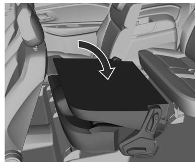
A continuación, tire de la palanca o de la correa hacia atrás y mueva el respaldo a la posición vertical hasta que enclave.
