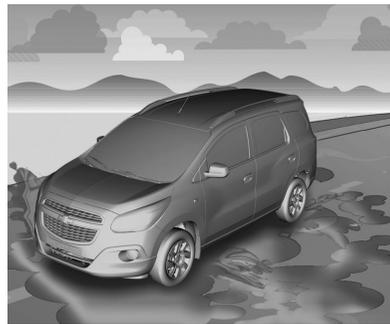
Puede llegar a acumularse tanta agua bajo los neumáticos que estos pueden deslizarse sobre el agua. Esta es una situación muy peligrosa. Esto puede ocurrir si hay mucha agua sobre la calzada y usted conduce rápido. Cuando se produce el fenómeno de aquaplaning, su vehículo tiene poco o ningún contacto con la calzada.
