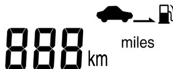
Este modo indica la distancia estimada que se puede recorrer hasta que se agote el combustible que queda en el depósito.
