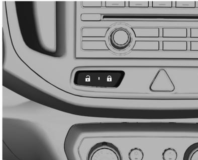
El LED de estado está integrado en el botón del cierre centralizado, cerca del centro del tablero de instrumentos.
