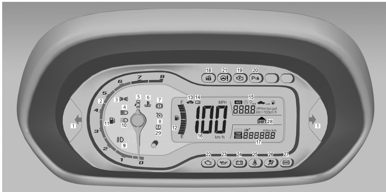
Indicadores de control del tablero de instrumentos (modelo A) – Para motores de gasolina y combustible flexible (flex)
